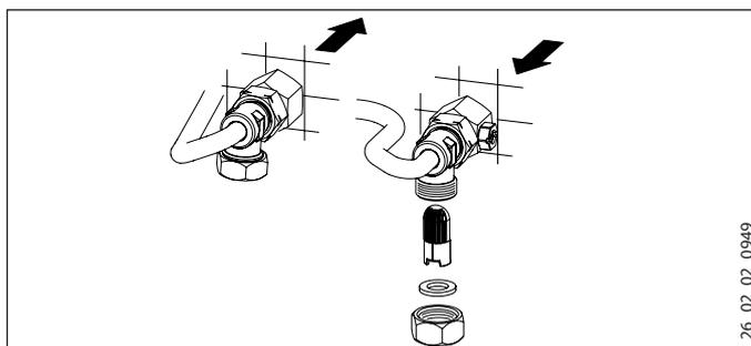
Очистить сетчатый фильтр в резьбовом соединении трубопровода холодной воды. Закрыть запорный вентиль в трубопроводе подачи холодной воды, демонтировать сетчатый фильтр, очистить его и установить снова.
